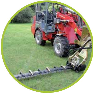
▲ Cette machine de la marque Kunzelmann a une barre de coupe robuste pour des talus, bordures et friches herbeuses.
